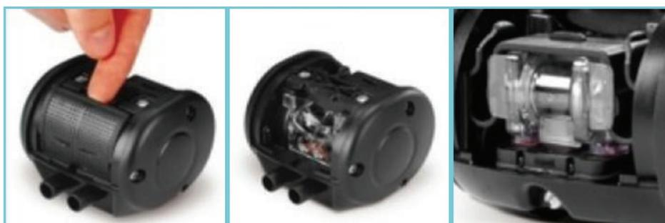
Le piston ou la valve peut se déplacer dans un bain d'huile afin de permettre un mouvement plus doux. La fréquence de pulsation est contrôlée par un pointeau qui peut être ajusté à l'usine ou être ajustable manuellement. Les variations de température peuvent affecter la fréquence des pulsateurs actionnés par le vide. Étant conscient de ce problème, il faut essayer de garder les pulsateurs à des températures normales de fonctionnement afin d'enrayer les fluctuations de fréquence.
